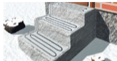
Монтаж одножильного нагревательного кабеля
